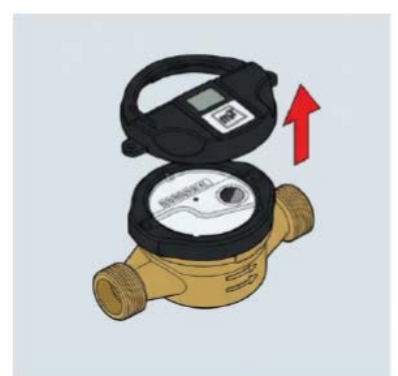
Abnahme des Funkadapters MT- WMRA2 vom Wohnungswasserzähler MT- SMARTMESS-JS senkrecht nach oben
