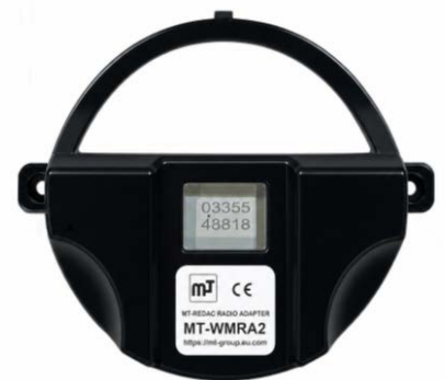
Funkadapter MT-WMRA2 Standard-Version mit innenliegender Antenne (höhere IP-Klasse)
